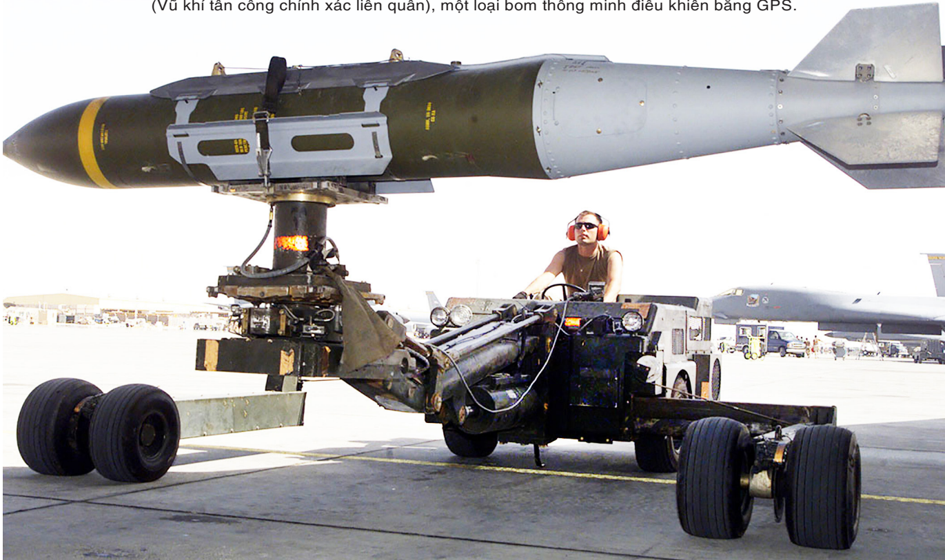
Một chuyên viên vũ khí gắn bom JDAM lên B-2, viết tắt từ “Joint Direct Attack Munition” (Vũ khí tấn công chính xác liên quân), một loại bom thông minh điều khiển bằng GPS.
