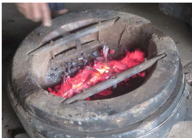
Đổ than hồng vào quạt để sấy khô khuôn trước khi đúc chĩnh đồng
