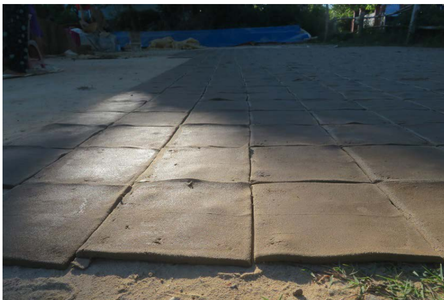
Những viên ngói vừa được đúc, mang đi phơi nắng sau đó sẽ tạo hình cong rồi mang đi nung
